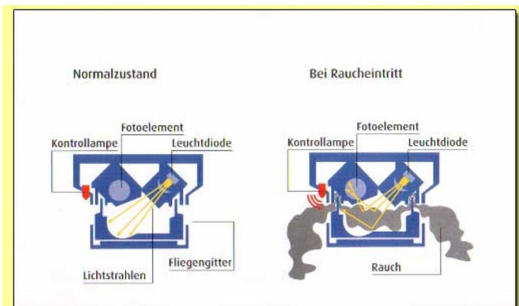
**Installation / Montage eines Rauchmelders** Rauchmelder lassen sich einfach mit den mitgelieferten Schrauben und Dübeln montieren. Für einen Mindestschutz gilt als Faustregel: ein Rauchmelder im Flur pro Etage sowie in den Schlafzimmern. Ganz nach
